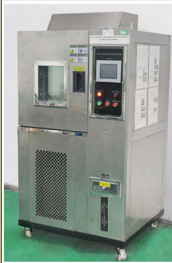
气候箱，带有 -90 至 +150^{\circ}C 的可调节温度范围，相对湿度可调节范围从 1 至 100%
