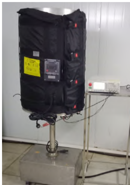
IPx6 测试后的绝缘电阻测量
