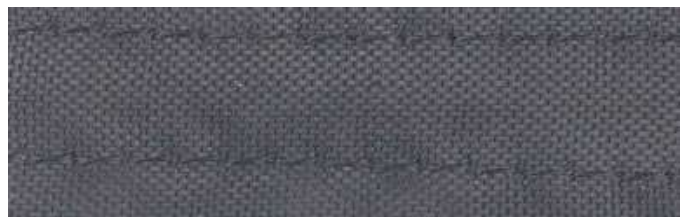
发热电缆在 120^{\circ}C 持续 96 小时：没变色，绝缘没熔化，性能没发生变化
