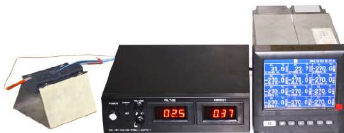
用于测量表面温度的设备，其作为毛毯加热器或布袋加热器表面 W/cm^2 的函数
