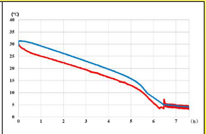
容器内的水温变化，当环境温度是 -35^{\circ}C 时，带有一个 0.1W/cm^2 ( 300W ) 的表面负载。可以看得出尽管加热功率增加，但罐的内部温度会继续缓慢下降。
