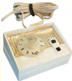
约1970年，在英国发热毛毯上的GEC功率设定（通用电气，英国）。预期的电阻在双金属和慢的断路器的上方清晰可见。（Ultimheat收集）
