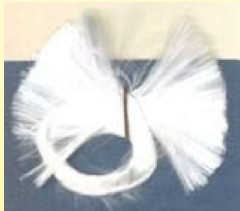
形成单根电线的玻璃丝束（玻璃丝的生产，大约在1960年，来自比利时的韦尔维耶的纺织学校的课程，Ultimheat博物馆）
