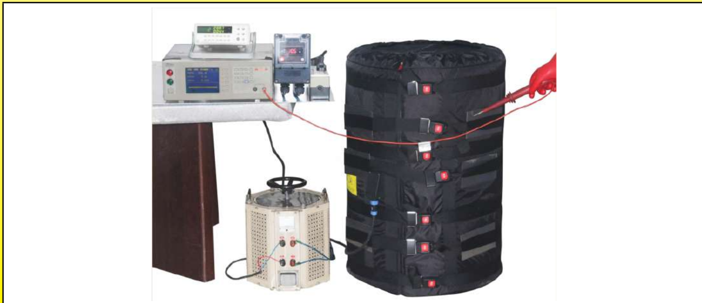
在热条件下总电流泄漏的测量设备
