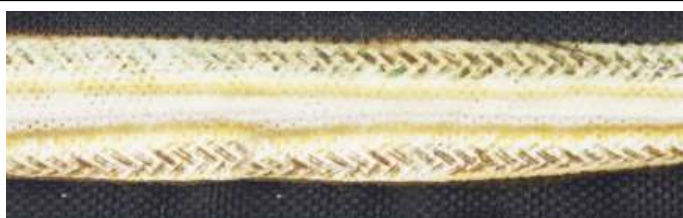
发热电缆在 245^{\circ}C 持续 5 分钟：PA66 已经熔化，并展现了 PTFE 的保护层，其没有变差。发热线的保护经常是通过 PTFE 和硅绝缘来完成的。
